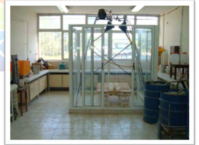
Toprak-Su Korunumu ve Erozyon Kontrol Laboratuvarı ve Yapay Yağmurlama Düzeneği
